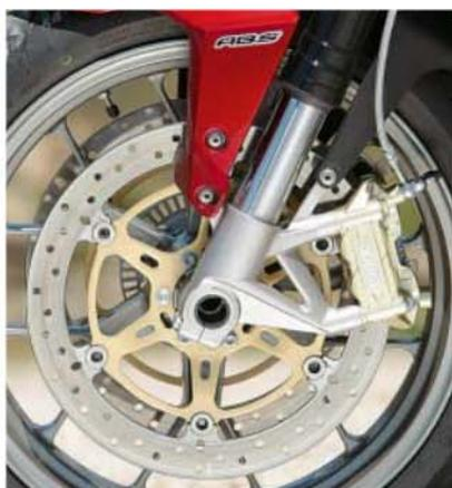
La **Aprilia** monta dos discos delanteros de 320 mm con pinzas de anclaje radial.
