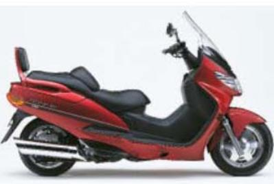
**1999-2002** Aparece como el scooter de mayor cilindrada (385 cc), desarrollado a partir del Burgman 250. Motor refrigerado por agua y alimentado por carburador de 36 mm. Declara prestaciones desconocidas. 2001, primera revisión. Alcanza al frontal y al alumbrado posterior, las guanteras varían su diseño interno. Mayor capacidad bajo el asiento (53 litros) y mejor la luz de cortesía. El asiento también cambia y permite regular el respaldo del conductor.
