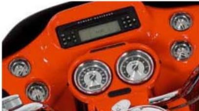
**Velocímetro**, cuentarrevoluciones, combustible, temperatura aceite y voltímetro, además de ¡mechero!
