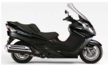
**2007-2009** El bastidor se modifica y el motor aumenta su cilindrada hasta 399 cc. Mejora sensiblemente en prestaciones (154 km/h reales). La posición de conducción se eleva ligeramente. En el tren delantero se monta un doble disco de freno. Nueva instrumentación y carrocería más voluminosa con influencia estética del Burgman 650. El peso aumenta en 11 kg. La capacidad bajo el asiento llega a los 65 litros y tiene apertura remota.
