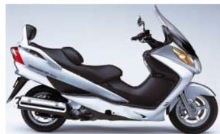
**2003-2006** Evolución más profunda. Se sustituye el carburador por inyección electrónica y en el motor también se realizan otras modificaciones internas. Inyección de aire en el escape para menores emisiones. El freno delantero mejora con una pinza de cuatro pistones (dos en el trasero). Diferente tarado de suspensión. Nueva carrocería con alumbrado delantero y trasero diferentes. Nueva instrumentación. Varía el diseño de las guanteras.
